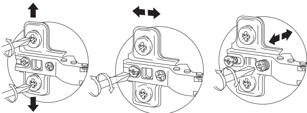
Установите тумбу на крепежи, отрегулируйте навесы при помощи отвертки. При установке, либо при навешивании тумбы необходимо следить за тем, чтобы верхняя плоскость тумбы была строго горизонтальна (используйте строительный уровень).
